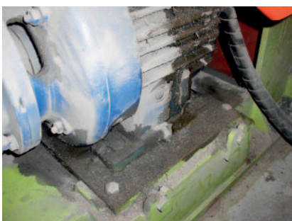
Fot. 3. Efekt „pocenia się” maszyny jest jedną z przyczyn powstawania zbędnych kosztów eksploatacji
